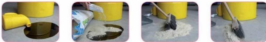
PROVA DI ASSORBIMENTO CON PRODOTTO ASSORBENTE/LEGANTE IN POLVERE, SUL SUOLO
